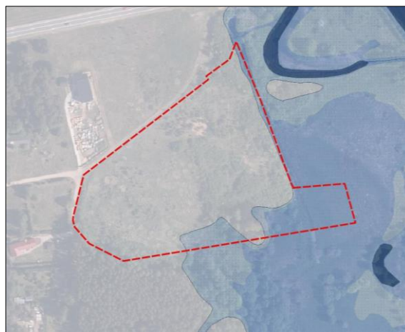
Ryc. 7 Obszar szczególnego zagrożenia powodzią, na którym prawdopodobieństwo wystąpienia powodzi jest średnie i wynosi 1%
